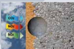
La penetrazione del gas acido trascina la carbonatazione ad un pH <9,5.
